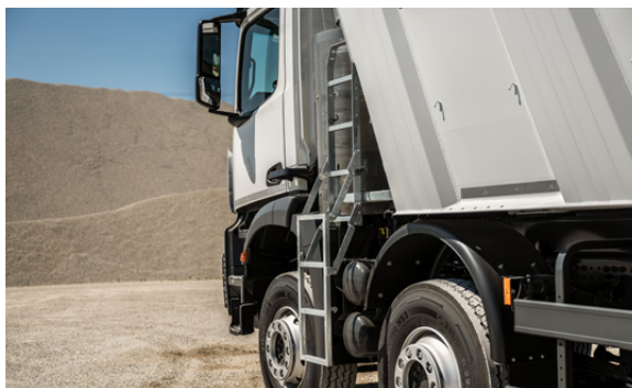
Vite déployée : accès latéral par échelle de montée.
