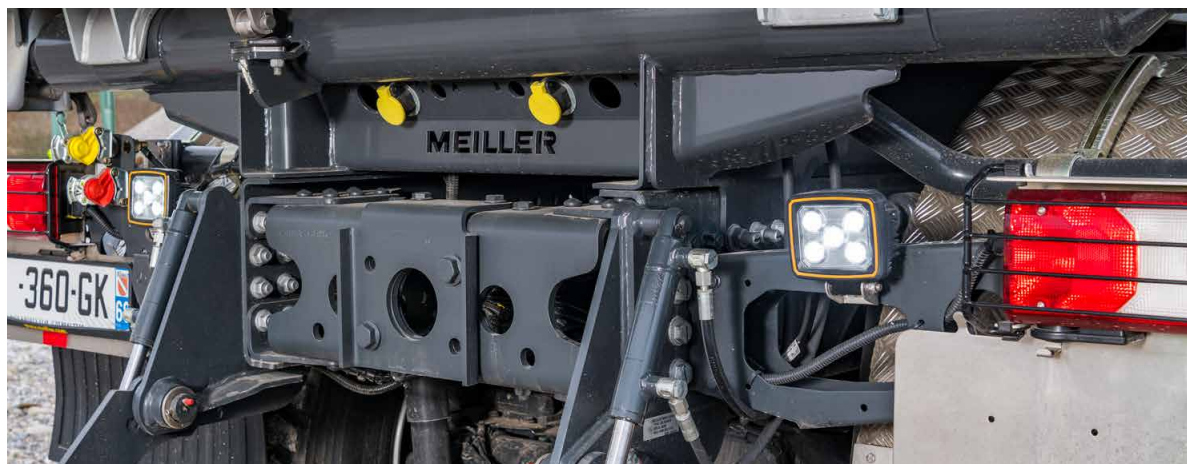
Adapté individuellement à votre utilisation : Bibenne MEILLER avec des feux de travail robustes et des raccords pratiques pour remorque
