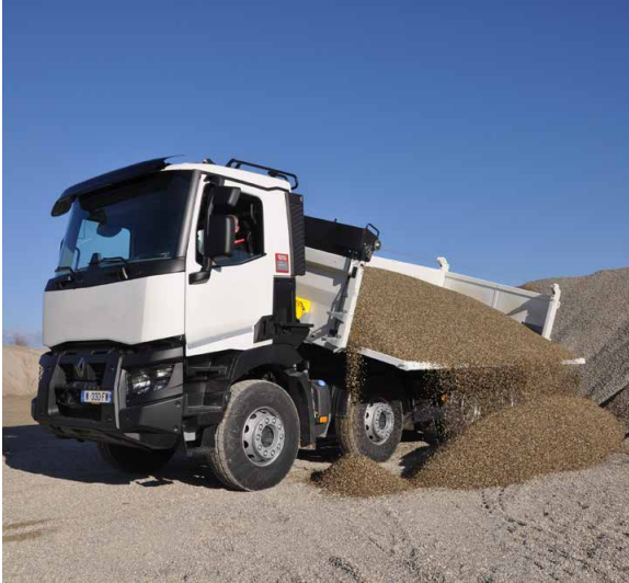
Bordmatic avec angle d'ouverture à 90° : La marchandise en vrac est déchargée loin du véhicule.
