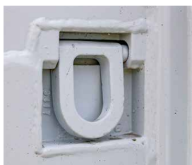
Œillets rabattables dans face avant retiennent la marchandise vers l'arrière (force 1 t).
