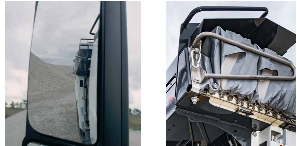
Une bonne vision dans le rétroviseur : Le guide de la bache coulissante MEILLER, la maintient toujours hors du champ de vision.
