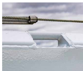
Sécurisation très flexible avec les œillets dans les ridelles (force 2 t).
