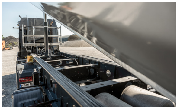
Cadre de châssis MEILLER rigide en torsion et en flexion
